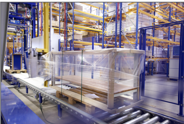
Automatische Verpackungsstrasse mit individuellen Packprogrammen/Packschemen für die einzelnen Produkte.
