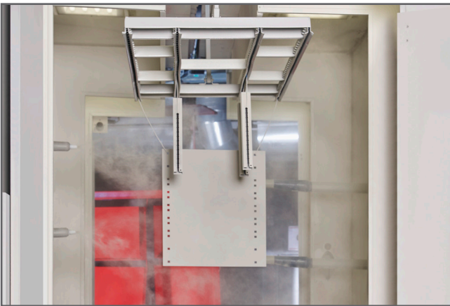
Automatische Pulverbeschichtungsanlage mit insgesamt 4 Beschichtungskabinen.
