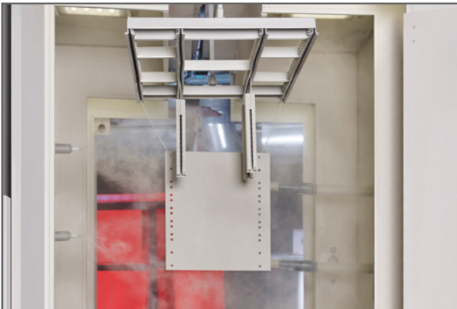
Automatische Pulverbeschichtungsanlage mit insgesamt 4 Beschichtungskabinen.
